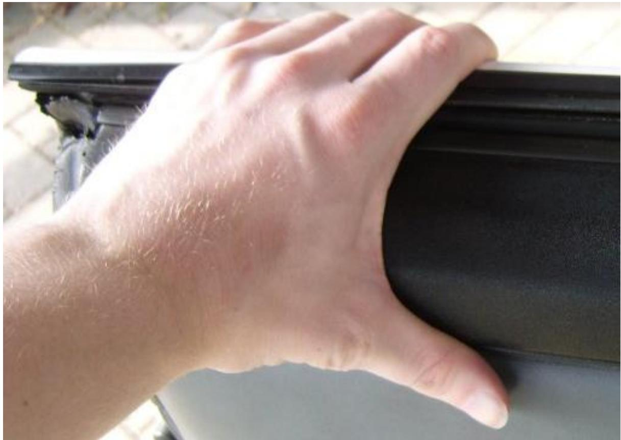
Mit einer Hand kann die Türpappe ein wenig (!) geneigt werden, während mit dem Handballen der anderen Hand die Kante etwas in Richtung Außenseite der Tür gedrückt und zugleich nach oben geschoben wird. Auf keinen Fall die Pappe zu stark neigen, da ansonsten die Verbindungsstellen zwischen Pappe und Kante beschädigt werden können. Mit der Handballenbewegung werden die Haltenasen der Kante, in der Zahl vier, aus den Halterungen gedrückt, eine nach der anderen.
