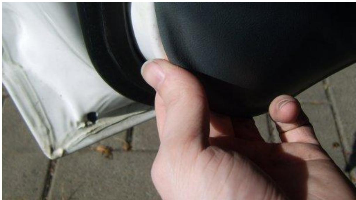
Ein solcher Clip sieht folgendermaßen aus. Wenn kein Abzieher für diese Dinger vorhanden ist, sollte es versucht werden die Clips zwischen den beiden runden Tellern zu erwischen, bevor Zug darauf ausgeübt wird. So reißen sie nicht aus der Pappe aus. Ein kräftiger Ruck holt die Pappe dann samt Clip aus der Tür raus.
