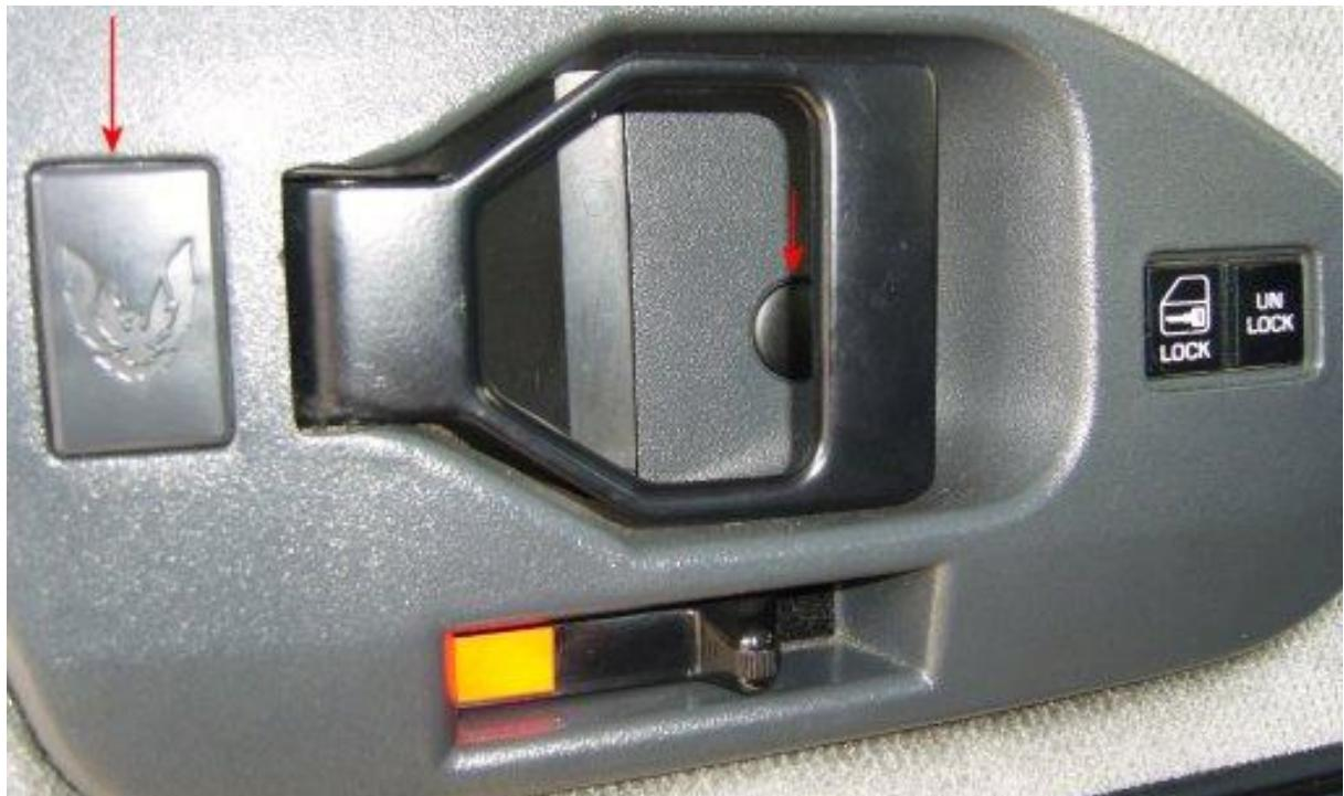
Die dahinter liegenden Schrauben können mit der 7er Stecknuss gelöst werden. Der Verriegelungsschieber ist nur auf die dahinter verborgene Schiene gesteckt. Entweder er wird jetzt mit etwas Kraft von vorne abgehebelt oder, wenn die Schrauben raus sind und mehr Platz vorhanden ist, hinten herum mit den Fingern herausgedrückt werden.
