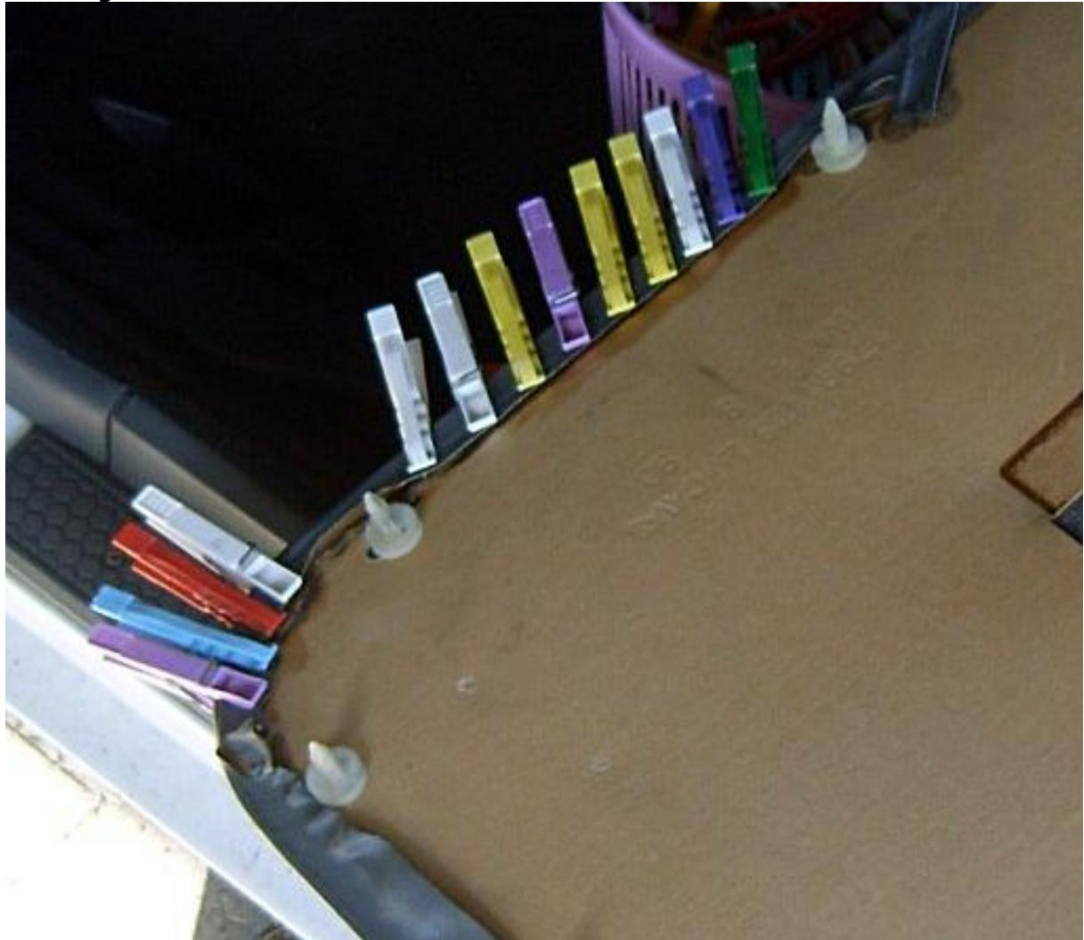
Anschließend darauf achten, dass die Gummilippe (sofern vorhanden) wieder korrekt an der Pappe angebracht ist und dann alles wieder in umgekehrter Reihenfolge an der Tür anbringen.
