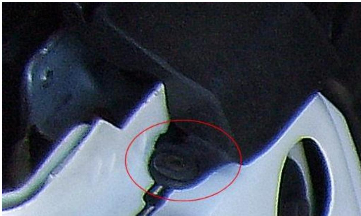
Mangels Plastikverstärkung sollten nun Unterlegscheiben mit den Schrauben verwendet werden, da sich die Schraubenköpfe ansonsten in das Gummi bohren.
